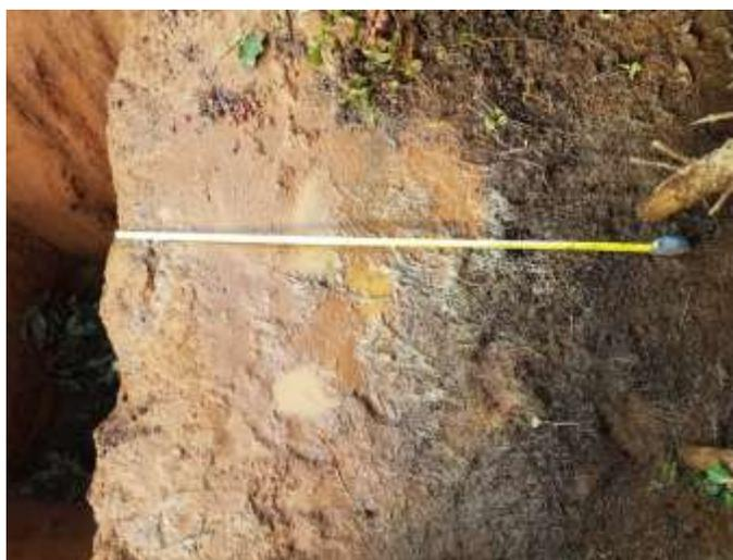
**Figura 3.** Camada compactada (crosta), formada pelo rodado do trator a uma distância de 1,2 m do tronco do café.
